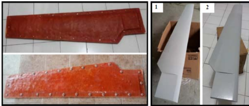
Gambar 10. master molding dan cetakan
