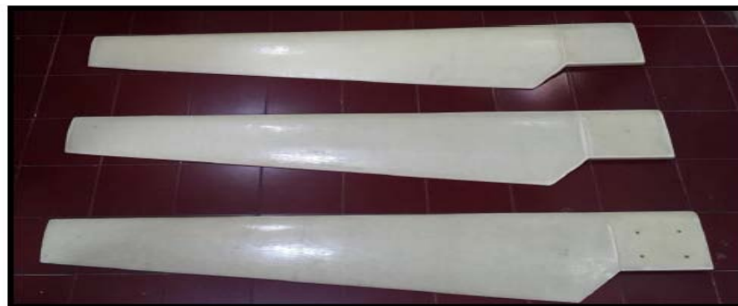
Gambar 11. Bilah Turbin Angin Komposit Hollow, Spar Ganda dan Core Foam
