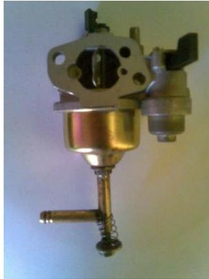
Gambar 5. Hasil manufaktur modifikasi karburator biogas
