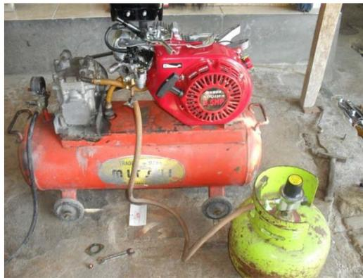
Gambar 6. Pengujian karburator biogas hasil modifikasi
